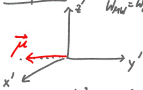
$\frac{d\vec{\mu}}{dt} = 0$  stationäre Magnetisierung im rot. KS
