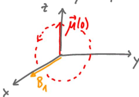
$\vec{\mu}$  führt Oszillation in z-y-Ebene aus
